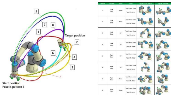
ภาพที่ 2 วิธีการเคลื่อนที่ของหุ่นยนต์อุตสาหกรรมทั้ง 8 รูปแบบ
